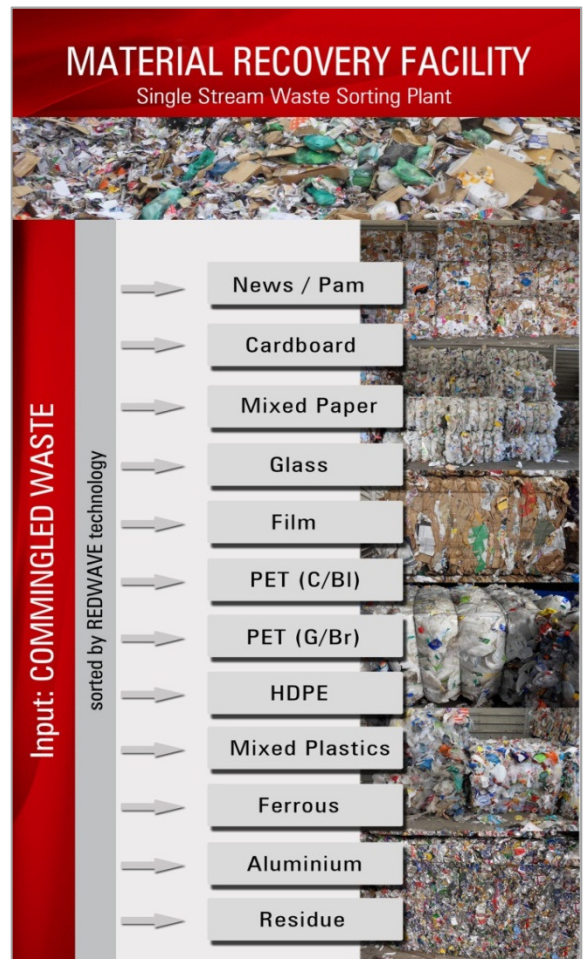
Das Aufgabematerial wird in 12 verschiedene Fraktionen unterteilt
