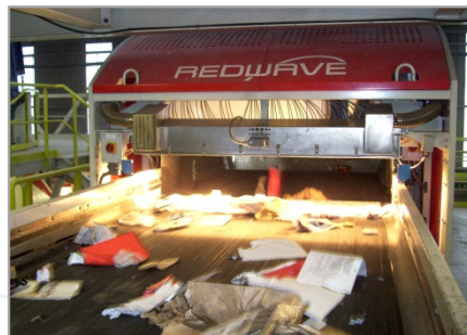
Grundon: Sortieranlage für gemischten Abfall
