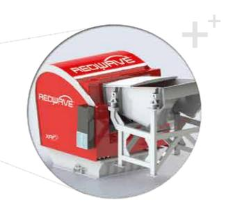
Le système de glissière REDWAVE XRF-M est une extension du système à bande REDWAVE XRF qui fait ses preuves dans le monde entier depuis de nombreuses années, notamment dans les installations de recyclage du verre. Le REDWAVE XRF-M a été spécialement conçu pour la récupération des métaux. Il allie les avantages de la technologie éprouvée XRF à ceux de la version à glissière qui améliore considérablement l'efficacité de la détection ainsi que la pureté du produit.
